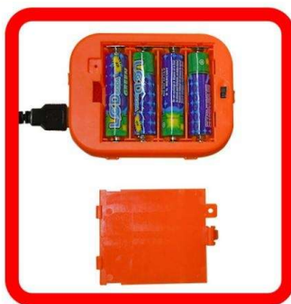
2. Otevřete pouzdro baterie a vložte 4 baterie
