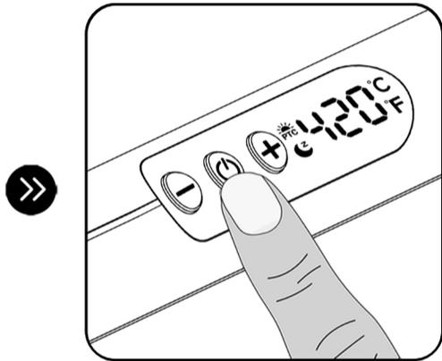
Doppelklick auf Taste
